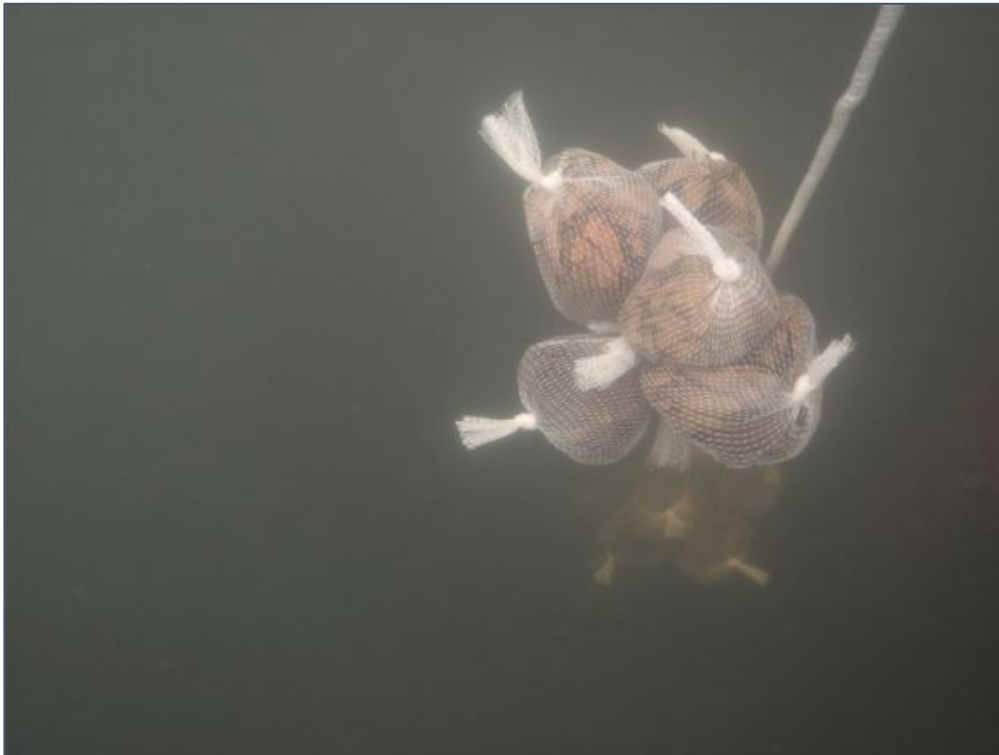
FIGURE 12 : ILLUSTRATION DU DISPOSITIF DE SUBSTRATS ORGANIQUES STANDARDS (SOS) IMMERGÉS
