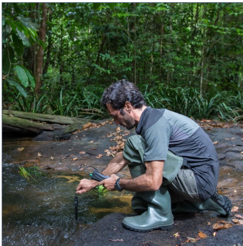
FIGURE 9 : MESURES DES PARAMETRES PHYSICO-CHIMIQUES IN SITU (PHOTO J. CHEVALIER)
